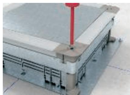
Mit Hilfe eines Schraubendrehers (Pozi driv Gr. 2) kann die Höhe der Unterflurdose eingestellt werden.
