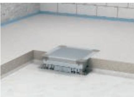
Beim Einsatz in schwimmend verlegten Estrichen/Heizestrichen auf Dämmschichten wird der Dosenkörper voll im Estrich eingebaut. Der Dosenkörper kann bei Bedarf durch eine Trennlage (bis zu 3 mm stark), die bis unter den Dosenoberahmen reicht, vom Estrich getrennt werden.
