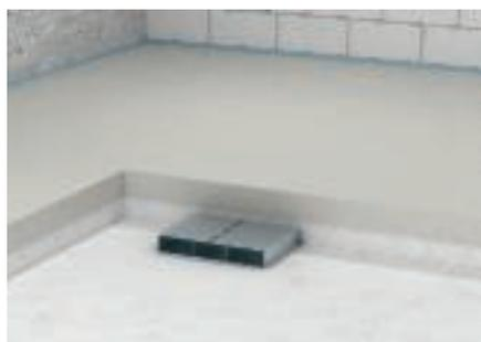
Unterflur-Installationskanäle in Fließestrich (z.B. Anhydritestrich) unterscheiden sich in der Montage nicht von Verbund- oder schwimmenden Estrichen. Da die Kanäle komplett geschlossen sind, gibt es keine Probleme bzgl. des flüssigen Estrichmediums.
