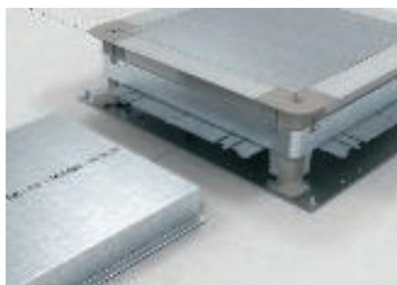
Die Seitenwände der Unterflurdosen werden mit einer Zange (z.B. Seitenschneider) entsprechend der Kanalgröße geöffnet und die entstehende Lasche nach oben gebogen.
