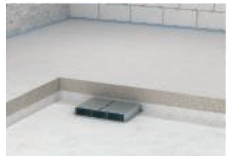
Die Montage der Unterflur-Installationskanäle in schwimmenden Estrich erfolgt genauso unproblematisch wie bei der Anwendung im Zement-Verbundestrich. Die Kanäle werden aus Schallschutzgründen innerhalb der Dämmlage verlegt.
