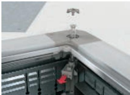
Montageschutzdeckel und die vier Verriegelungsdeckel von der Unterflurdose entfernen. Schieber mit zwei Fingern greifen und nach innen ziehen. Nivellierschrauben nach oben entfernen.
