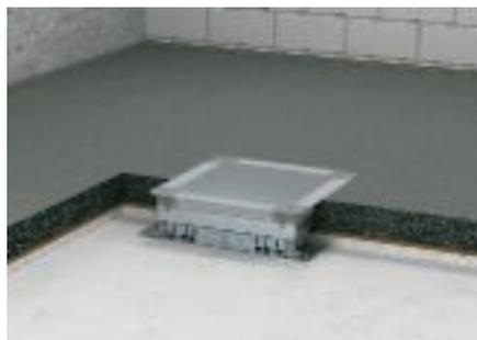
Eine Montage der Unterflurdosen UZD-3 und UGD-3 im Gussasphalt-Verbundestrich ist möglich. Die hohen Temperaturen beim Einbringen der heißen Masse stellen kein Problem dar. Der estrichbündige Dosenoberrahmen wird voll im Estrich eingebettet.
